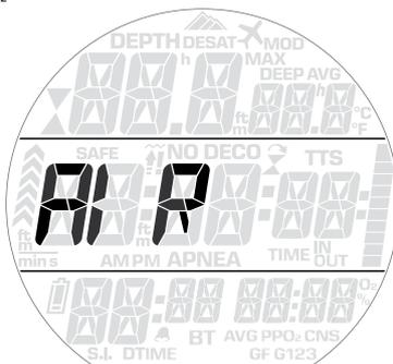
Selezionando **NITROX**, si accede a un sottomenù in cui è possibile definire la percentuale di ossigeno della miscela ( $O_2\%$ ) e il valore massimo della pressione parziale di ossigeno ( $ppO_2max$ ) per tre miscele di respirazione. Il valore massimo possibile per la  $ppO_2max$  è 1,6 bar. La maggior parte delle agenzie didattiche consiglia di non superare il valore di 1,4 bar.
