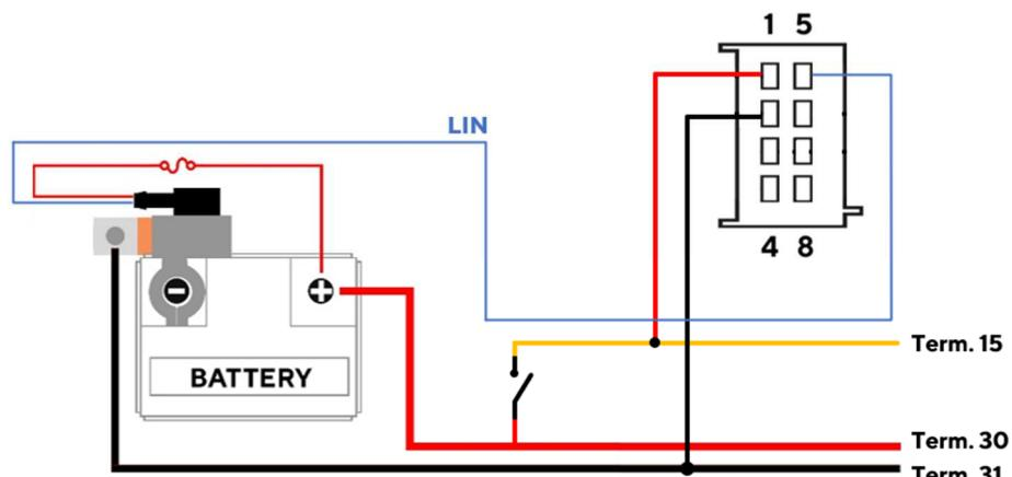
Retire todo el sistema del polo negativo de la batería e instale el IBS en el polo en su lugar.
