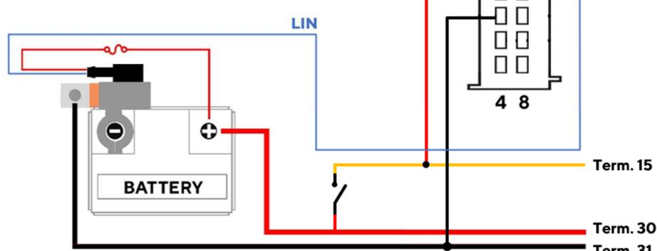
Disconnettere l'intero sistema elettrico dal polo negativo della batteria e installare l'IBS sul terminale.
