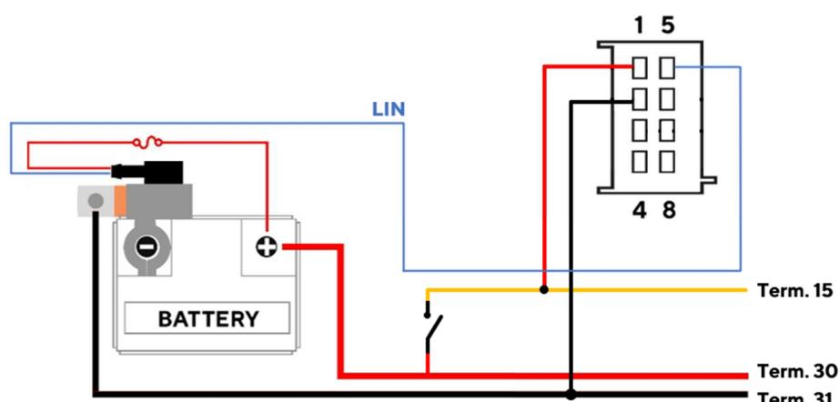
Retirez l'ensemble du système du pôle négatif de la batterie et installez l'IBS sur le pôle à la place.
