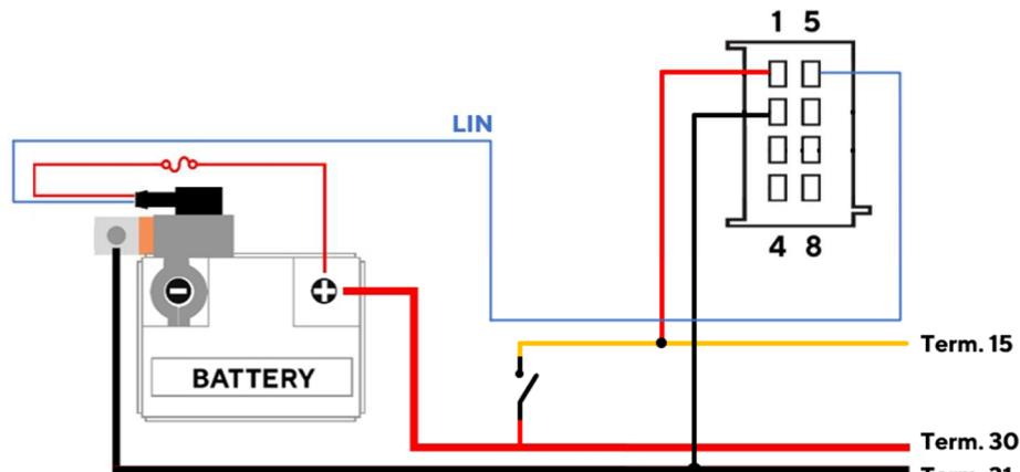
Für die Installation das gesamte System vom negativen Pol der Batterie abtrennen und dort stattdessen den IBS (Intelligent Battery Sensor) anbringen.
